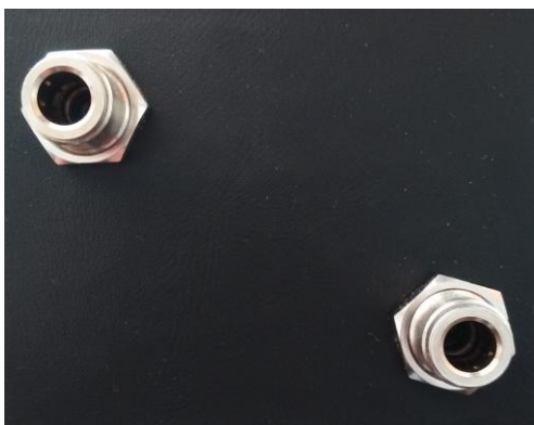
Obr. 22 Uchycení antén – vlevo pro „volume“ anténu, vpravo pro „pitch“ anténu
