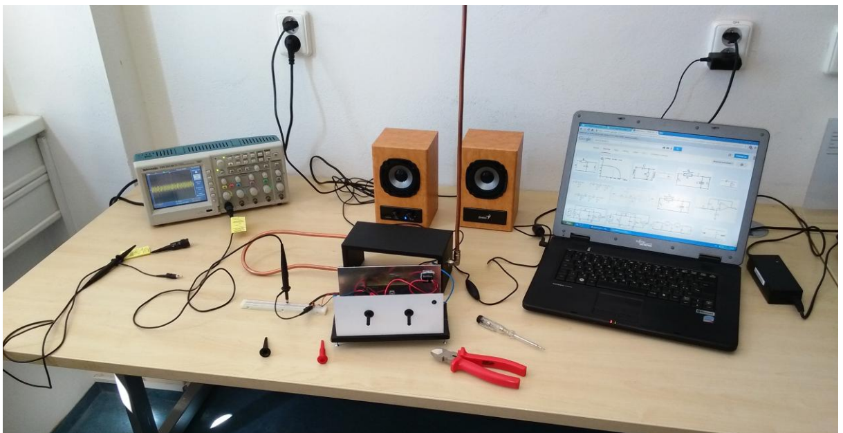
Obr. 23 Měření odezvy antén v závislosti na vzdálenosti
