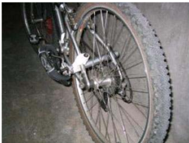
Sedlová trubka blokuje rotaci zadního kola a je přichycena k rámu kola zamykacím zařízením.
